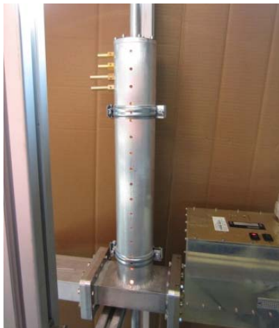
Laborreaktor und Simulation des Feldes für mikrowellenbeheiztes katalytischen Reverse Water Gas Shift
