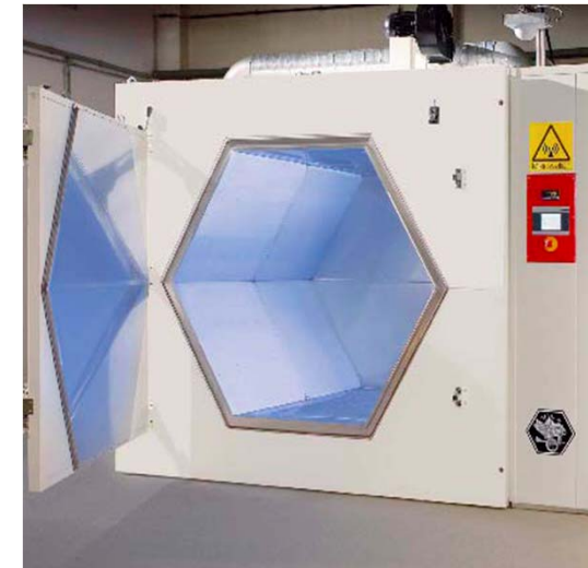
Bild einer 1 m 3 Mikrowellenkammer zum Aushärten von Faserverbundwerkstoffen
