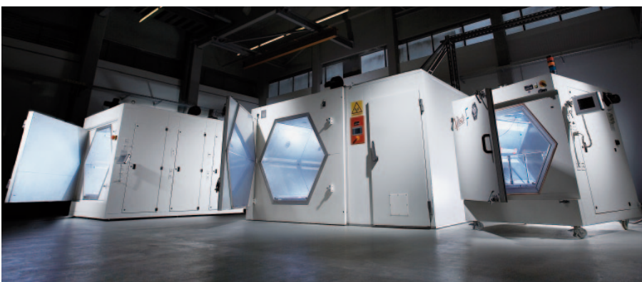
Aushärten mit Mikrowellen: Die HEPHAISTOS Technologie ist eine von vielen Innovationen, die am Tag der Energie zu sehen waren.
